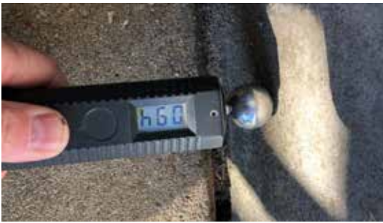
Vochtmeting met de Hydromette Compact B vochtmeter (magnetische meting). 94 digits => 6, 0 gewichtsprocent vocht.
