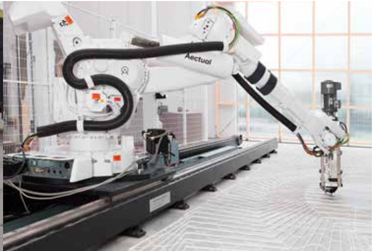
Een 3D printer om een terrazzovloer met motief te maken.
